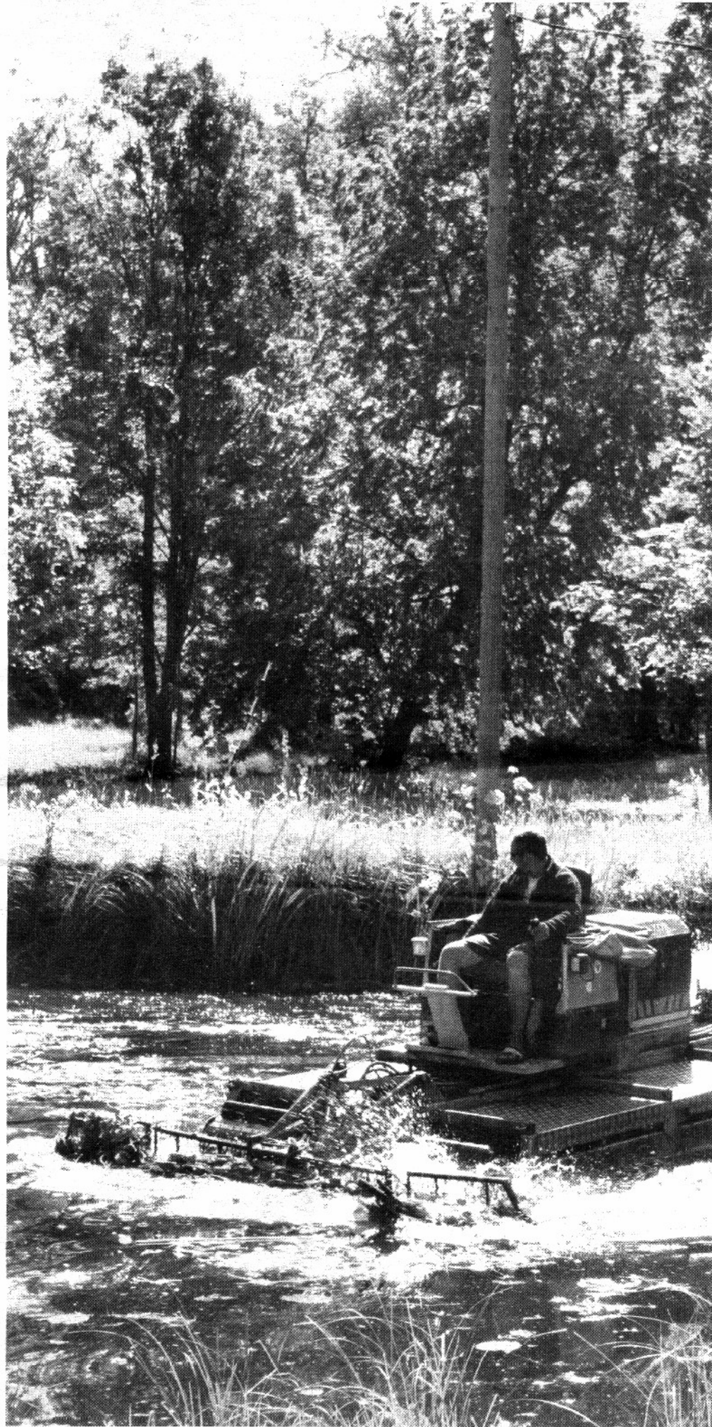
Põhja-Rootsis toodetud väikes amfiibraktori nelja meetri pikkused terad võimaldavad löigata kaldavõsa ja roogu ning puhastada järve veetaimedest. ANDRES VARE
